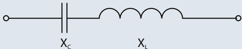
Bild 13: Ersatzschaltbild einer verdrosselten Kompensationsstufe
