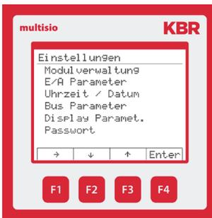
Der Scanmode kann auch über das Display gestartet werden (Fenster: Einstellungen, Menüpunkt: BusParameter):
