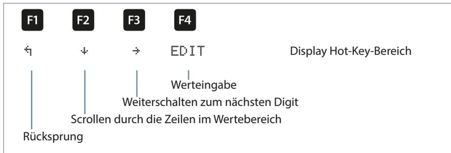
Wenn die Einstellung verändert wurde, erscheint beim Drücken der Taste + (Scrollfunktion) nach der zweiten Zeile folgende Anzeige im Hot-Key-Bereich des Displays:
