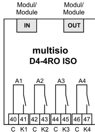
IN / OUT: Modulbus / Versorgungsspannung
