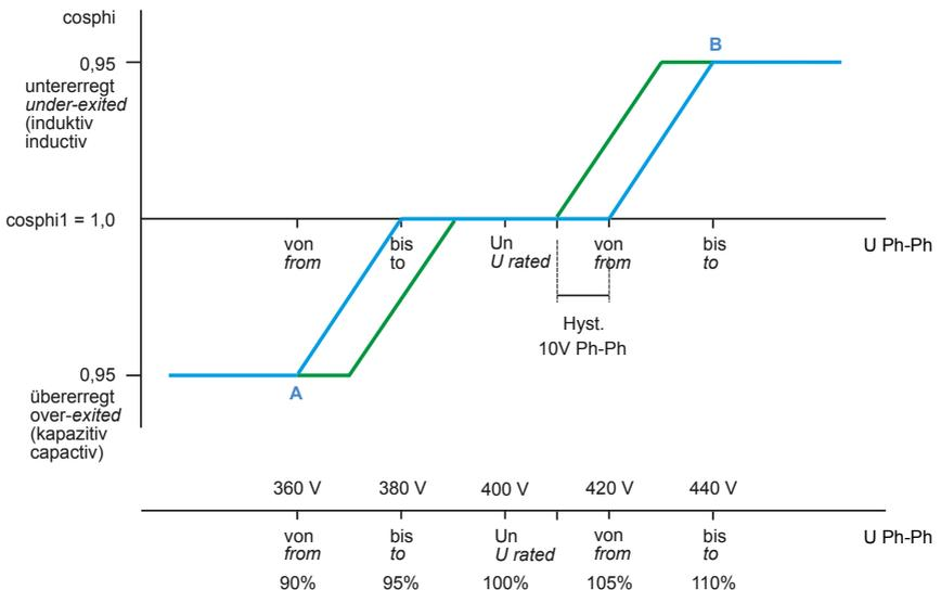
**Modus P ► φ (Änderung durch Wirkleistungskennlinie):**
