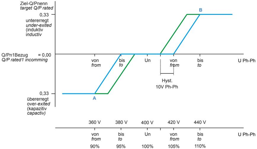
**Modus P ► Q/Pnenn (Änderung durch Wirkleistungskennlinie):**
