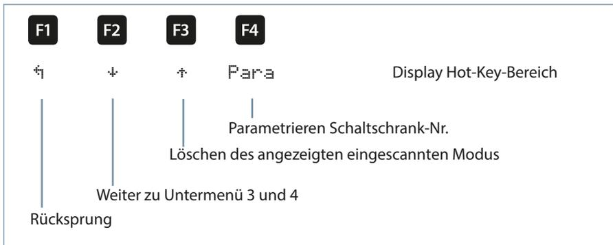
**Untermenü 3:** Modulerkennung (Blinken Ein und Aus). Hier kann das entsprechende Modul in einen Blinkmodus versetzt werden und somit eindeutig zugeordnet werden.
