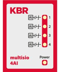
Power-LED an: Betriebsspannung liegt an
